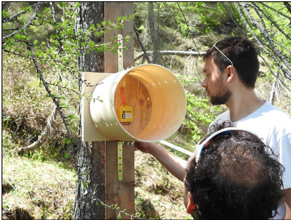
Figura 2.1.2: installazione del data-logger a 1,5m da terra su l'apposito supporto
