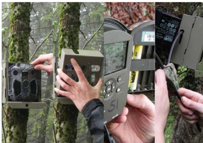
Fig. 12 Fasi di preparazione e di fissaggio della fototrappola al supporto. Foto di Veronica Lascialfari.
