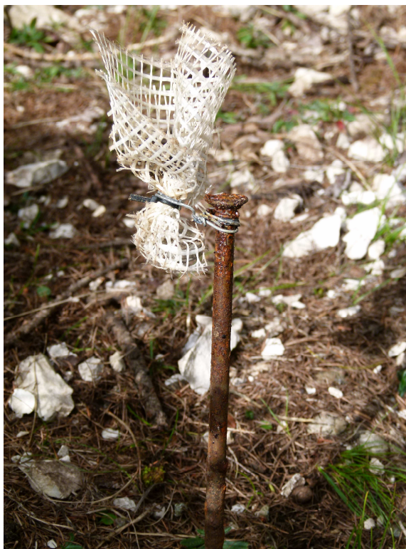
Sensore avvolto nella retina all'estremità del chiodo.
